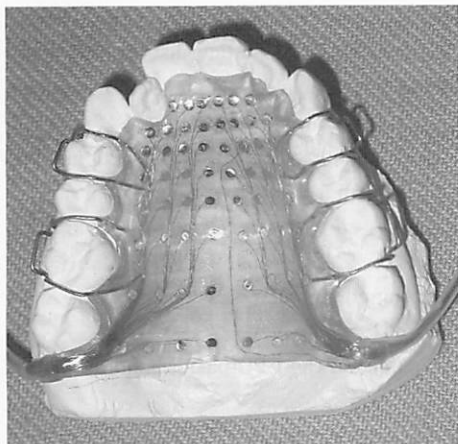
図1 EPGパレット：62個の電極を配した人工口蓋
